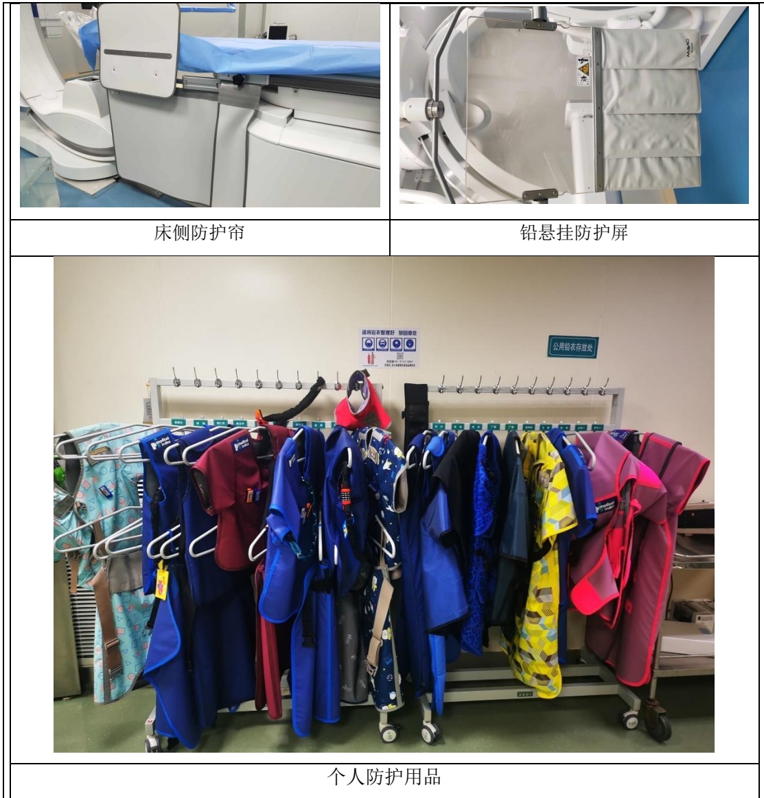
图3-12 本项目配备剂量检测仪器及个人防护用品
