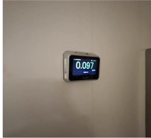
区域辐射测量仪（注射窗口外探头）
