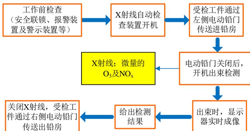
图2-2 本项目工业CT检测装置工作流程及产污环节
