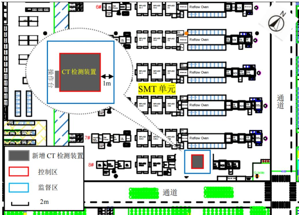
图3-1 EF电子车间SMT单元平面布置及分区示意图
