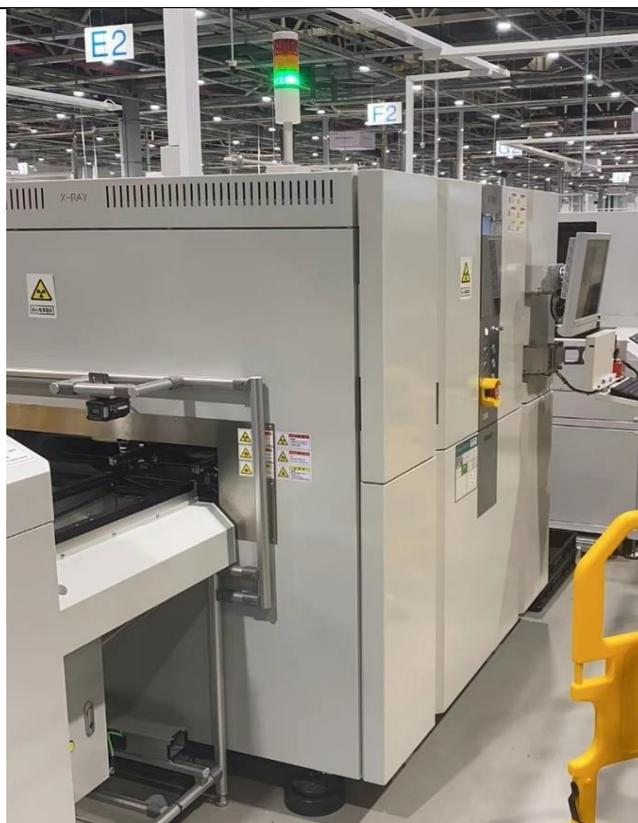
图2-1 VT-X750型工业CT检测装置外观
