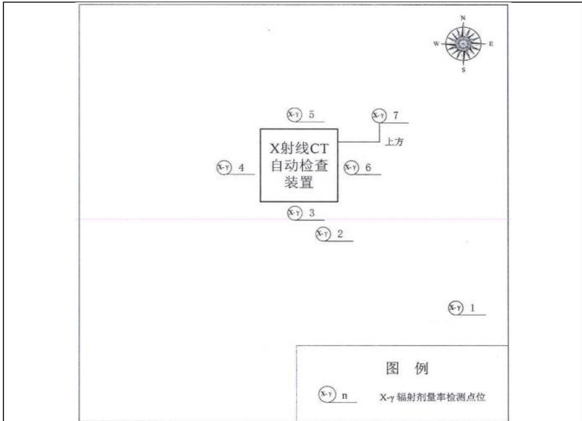
图7-1 工业CT检测装置铅房周围监测布点图
