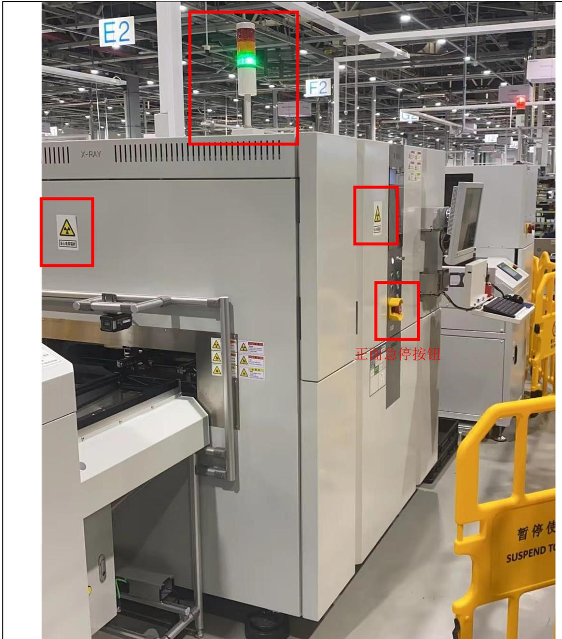
图3-2 工业CT检测装置工作状态指示灯和电离辐射警告标志
