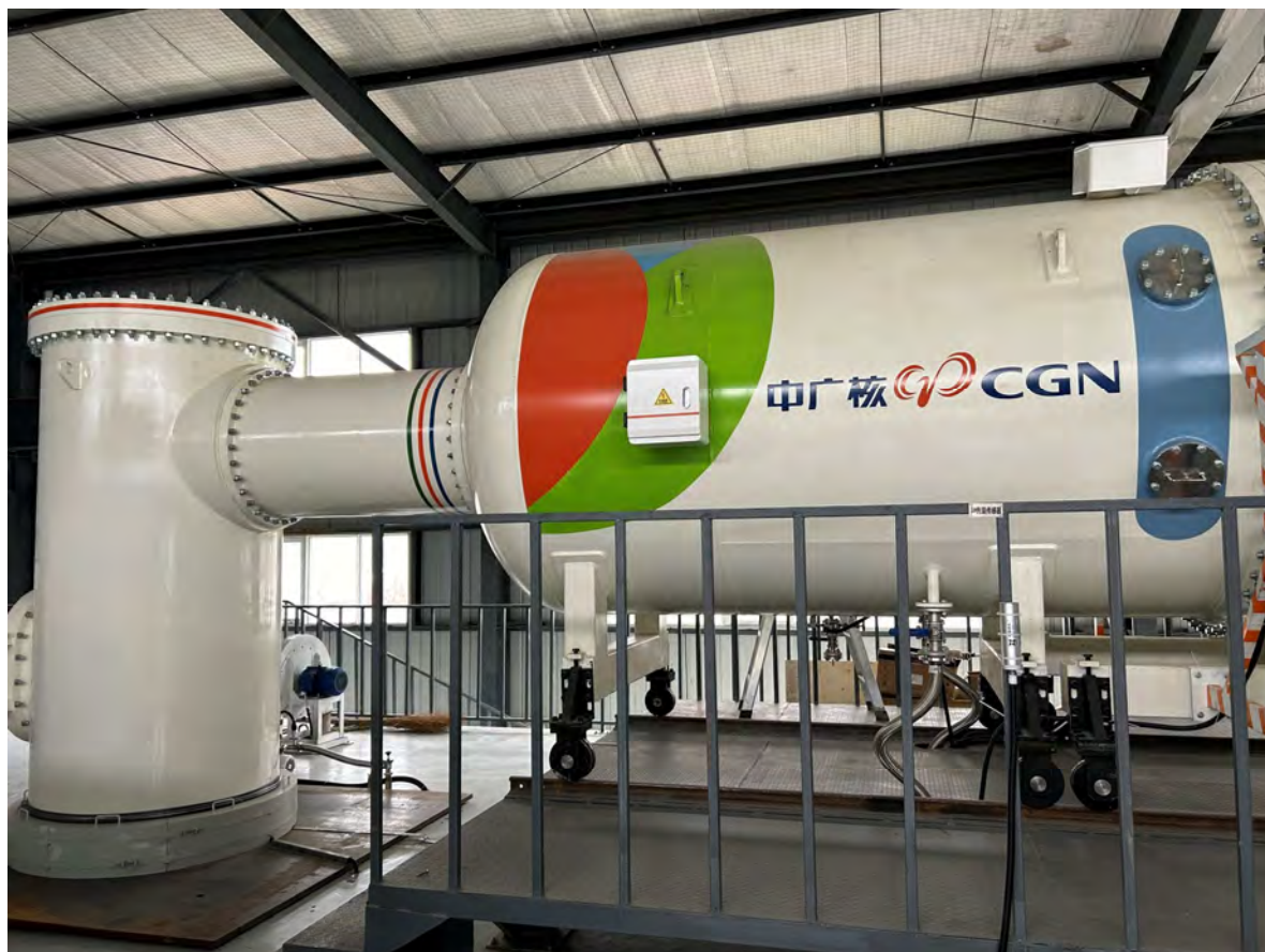
图 9-2 卧式工业电子加速器主机钢桶及侧钢桶外观示意图
