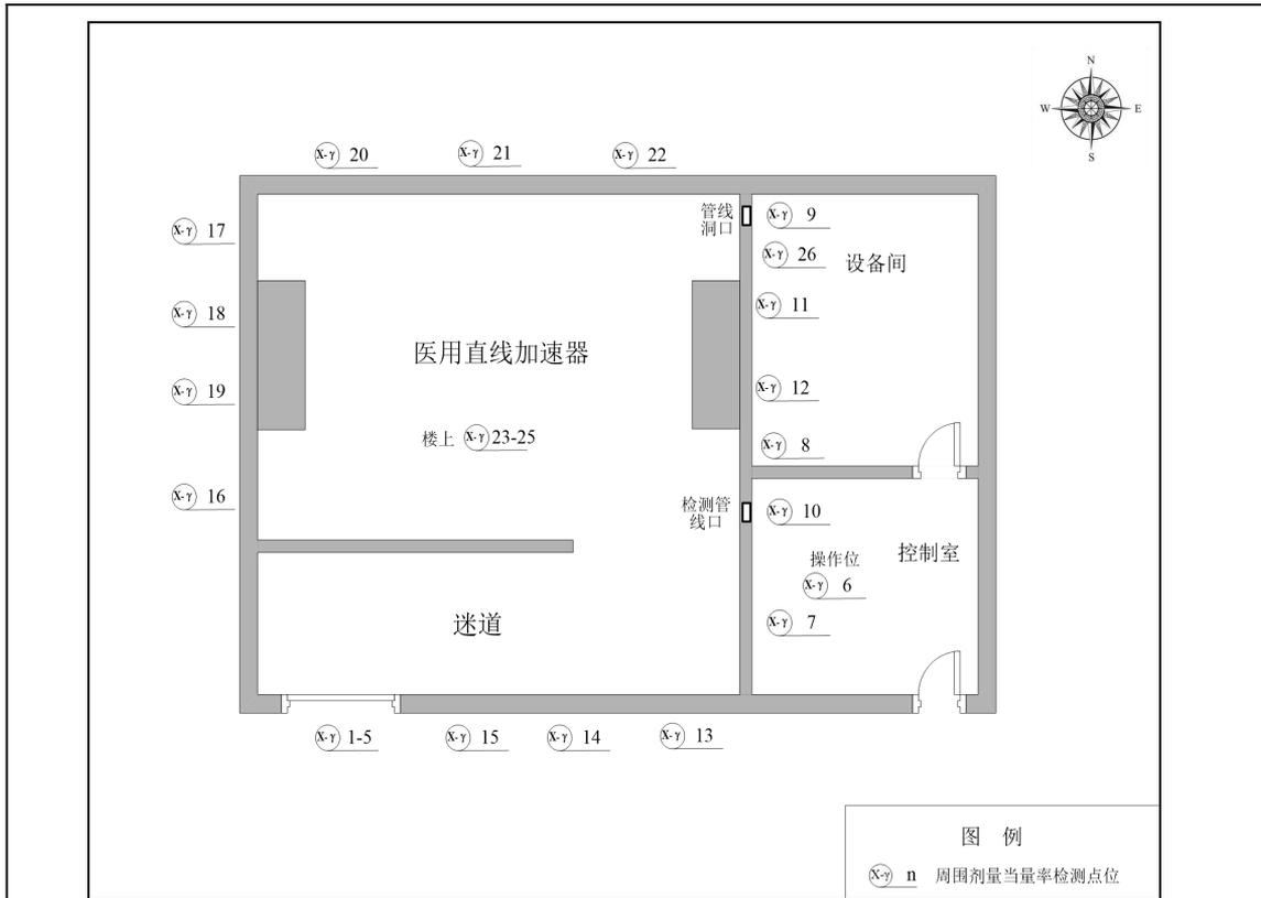
图7-6 核医学中心工作场所（<sup>18</sup>F）周围X-γ辐射剂量率监测布点图
