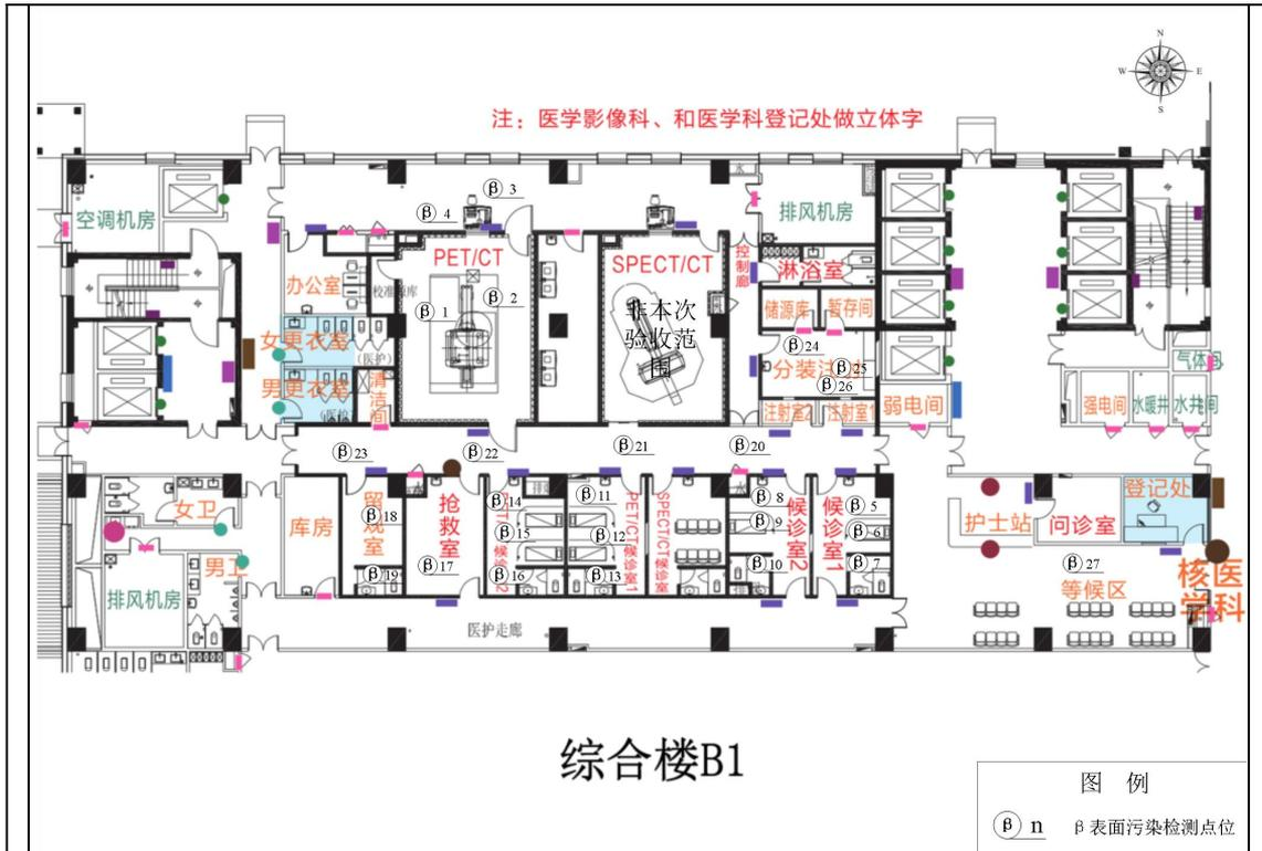
图7-2 PET/CT机房周围β放射性表面污染水平监测布点图
