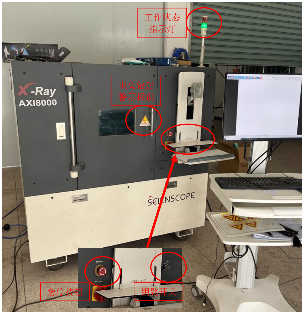
图3-4 工业X射线探伤装置电离辐射警告标志、工作状态指示灯、急停按钮和钥匙开关
