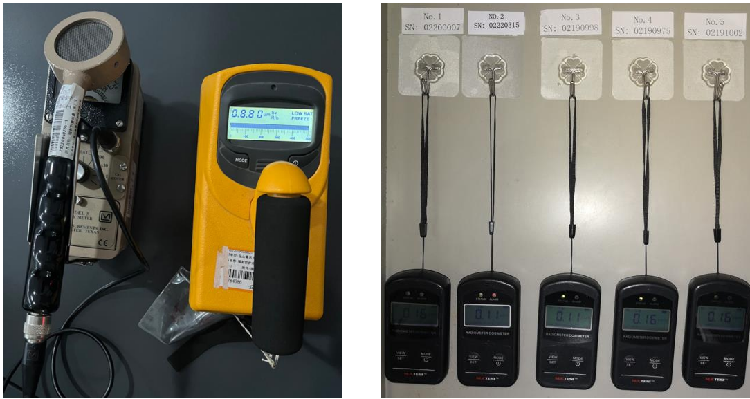
图3-5 本项目配备辐射巡测仪和个人剂量报警仪
