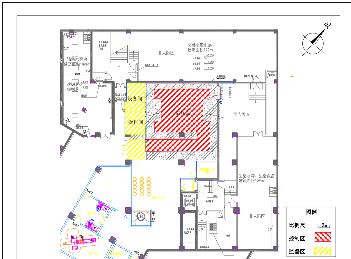
图 10-1 医用直线加速器机房平面布局及分区示意图
