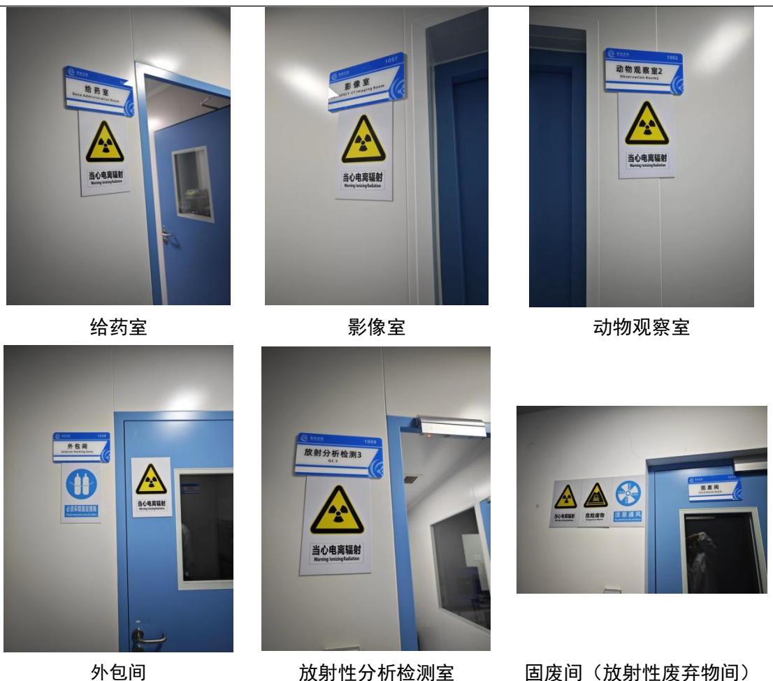
图3-4 放射性同位素实验室工作场所出入口及各房间门上电离辐射警告标志
