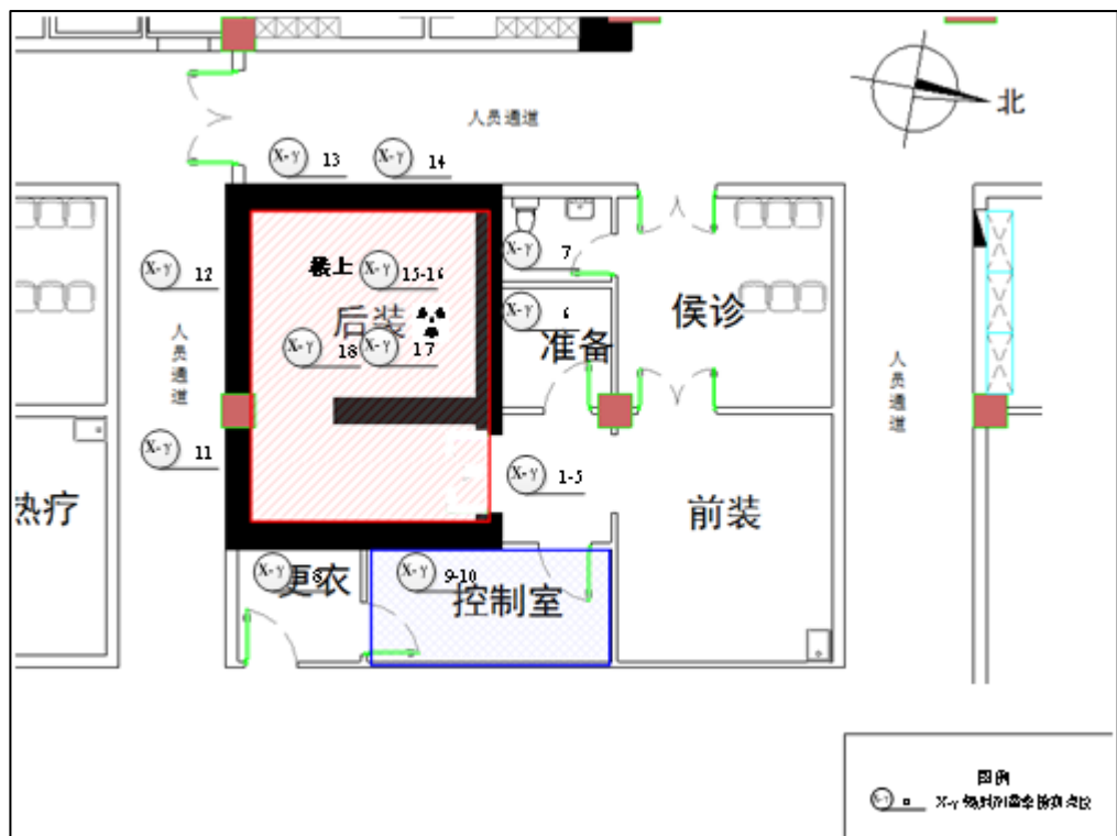
图 7-1 后装机房周围 X-γ 辐射剂量率现场检测点位示意图
