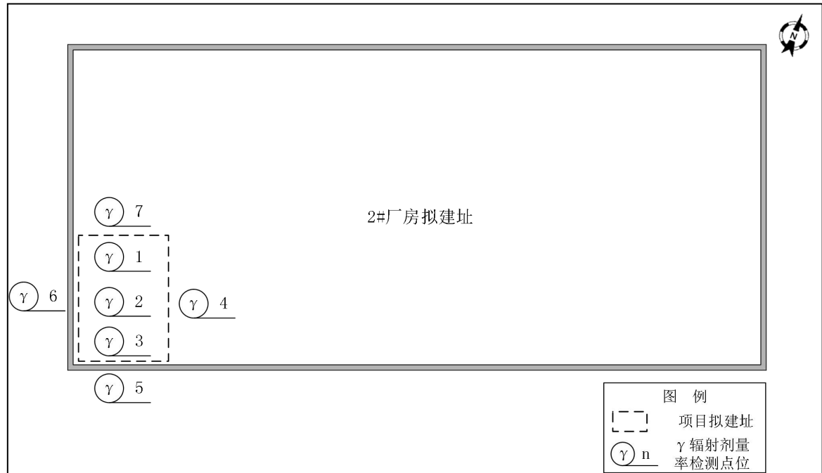
图 8-6 新建 2 台电子加速器辐照装置项目拟建址及其周围环境 \gamma 辐射剂量监测点位示意图
