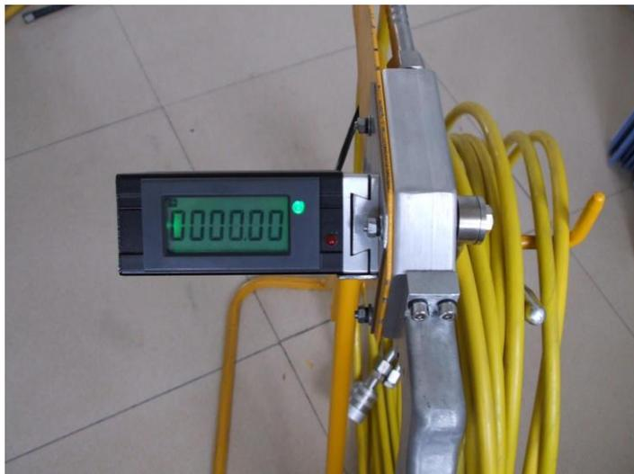
图 9-7  $\gamma$  射线探伤机源辨位置指示系统
