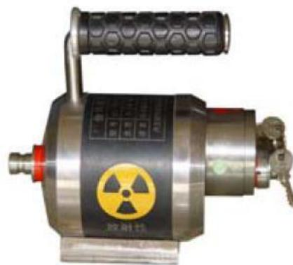
$^{75}\text{Se}$   $\gamma$  射线探伤机
