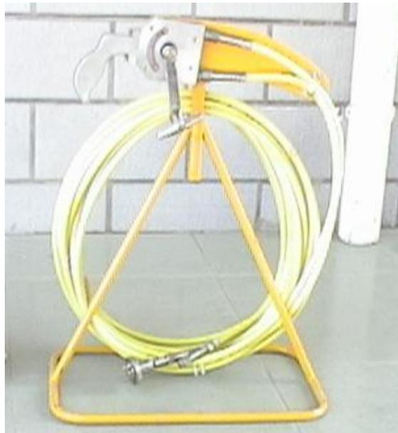
图 9-5  $\gamma$  射线探伤机控制部件
