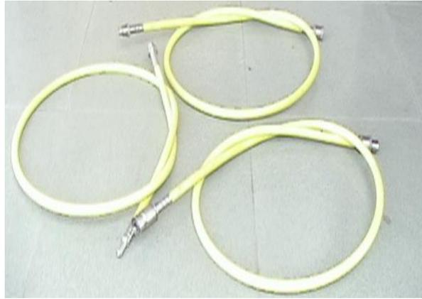
图 9-6  $\gamma$  射线探伤机输源管
