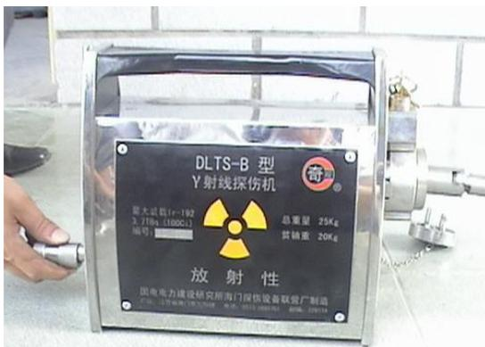
$^{192}\text{Ir}$   $\gamma$  射线探伤机
