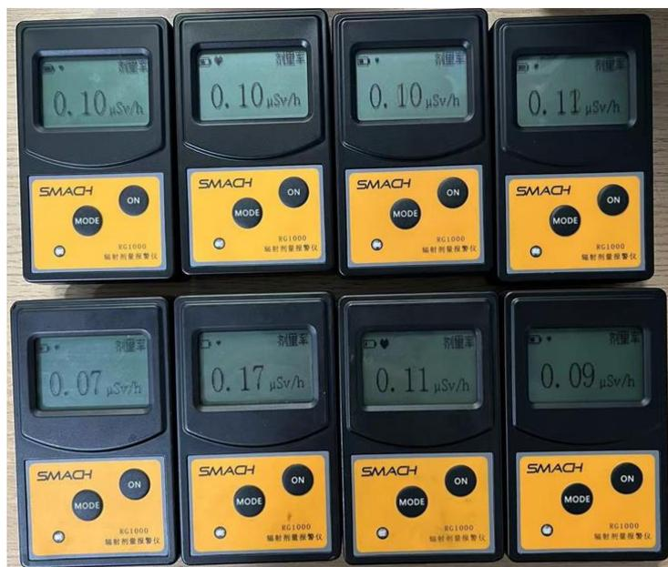
图3-20 本项目配备辐射巡测仪和个人剂量报警仪
