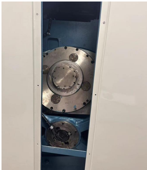
图 3-16 手动关源装置
