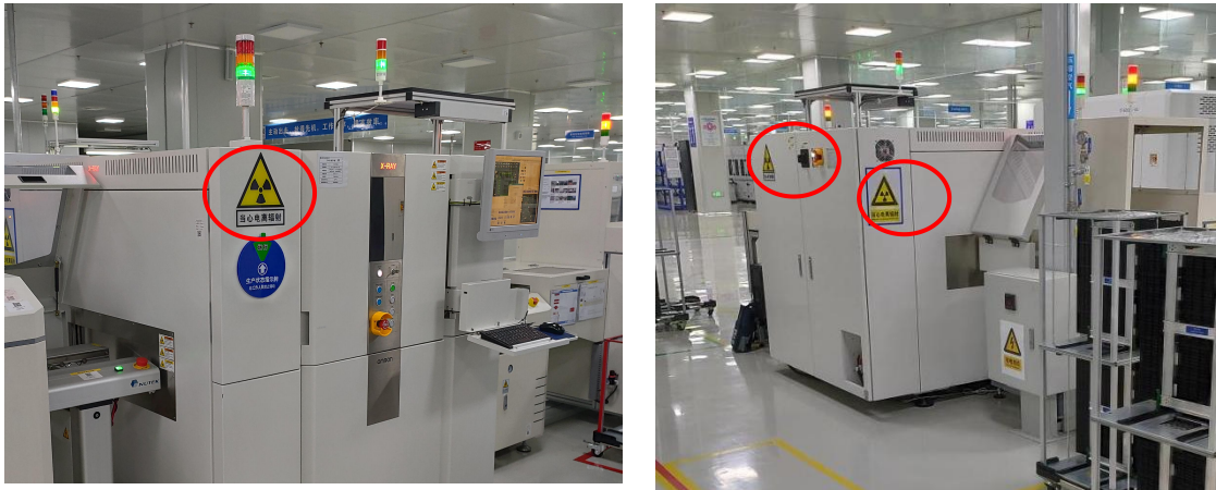
图3-5 VT-X750型X射线CT自动检查装置的电离辐射警告标志
