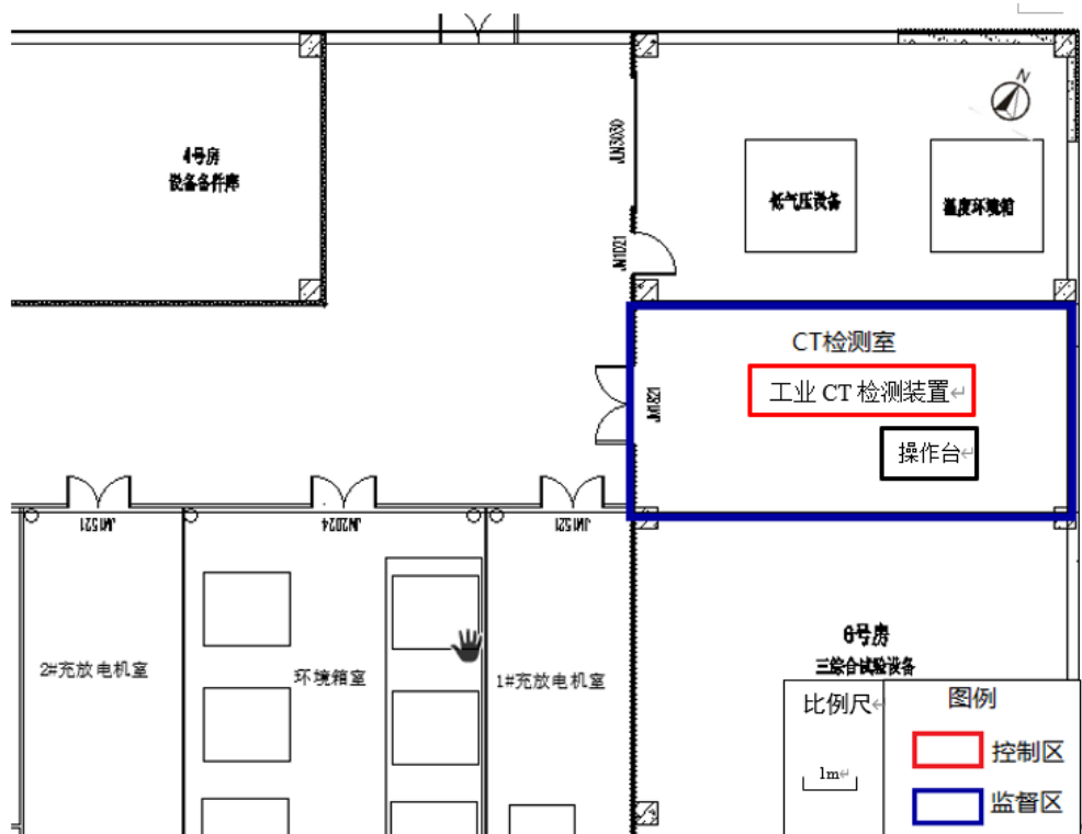
图3-1 CT检测室平面布置及分区示意图
