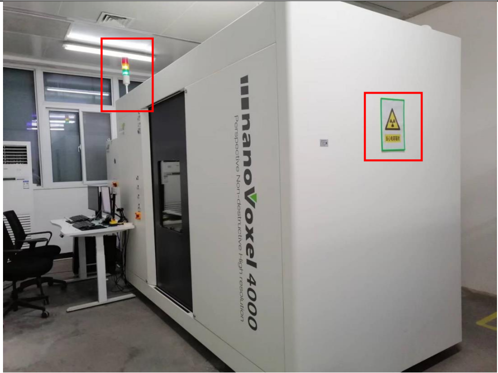
图3-2 工业CT检测装置工作状态指示灯和电离辐射警告标志
