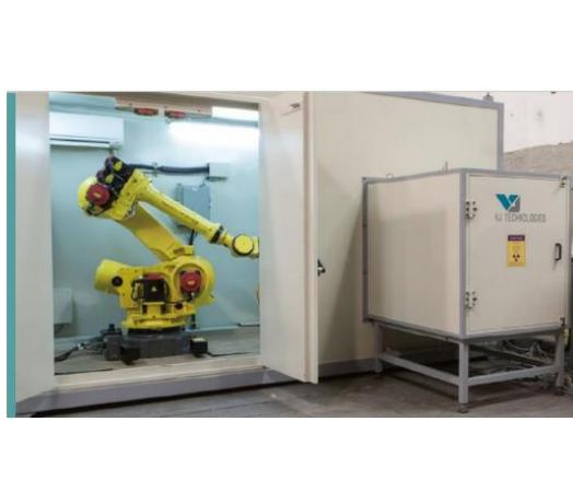
图 9-8 VJT-450 型工业用 X 射线探伤装置外观图
