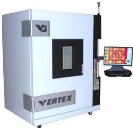
图 9-3 Vertex-130 型工业 CT 装置外观图
