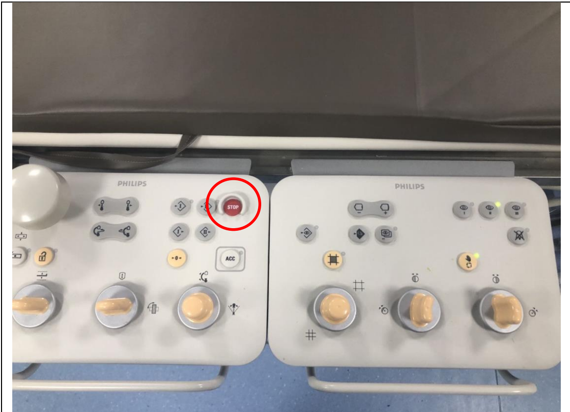
图3-5 DSA控制室及机房内的急停按钮
