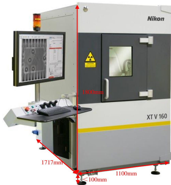
图 9-1 本项 XTV160 型工业 CT 检测装置外观图
