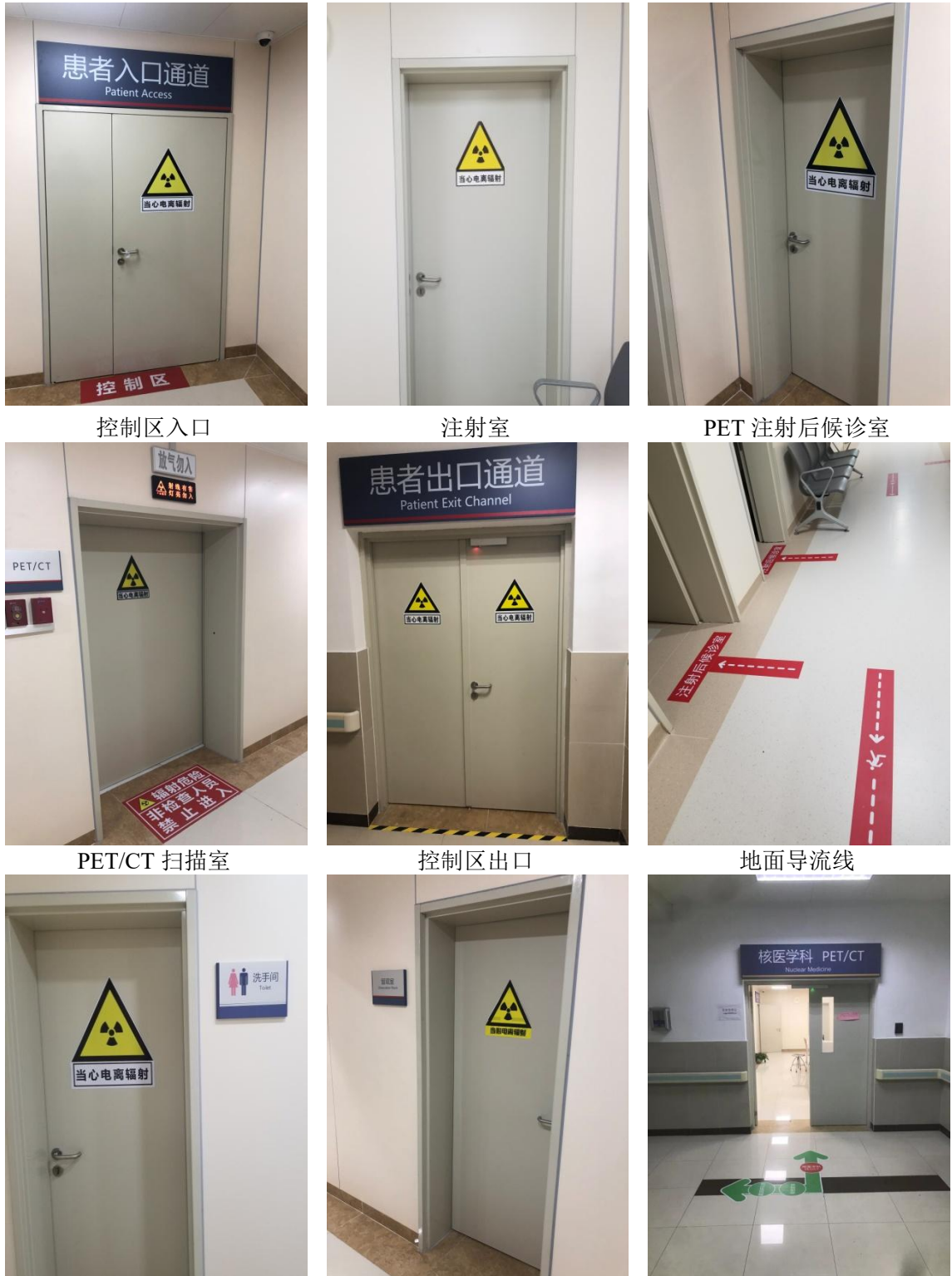
病人专用卫生间 留观室 核医学科入口 图3-2 本项目核医学工作场所工作状态指示灯、电离辐射警告标志和导流线
