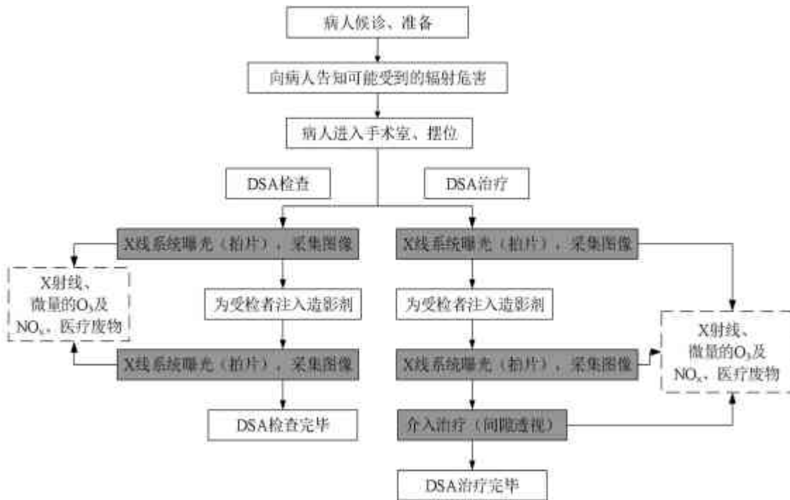
图 2-4 本项目 DSA 工作流程及产污环节示意图
