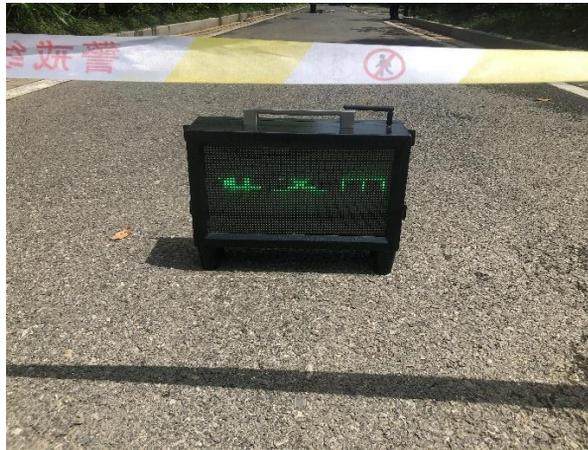
图3-3声光报警装置和警戒线
