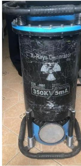
图2-1 本项目移动式X射线探伤机
