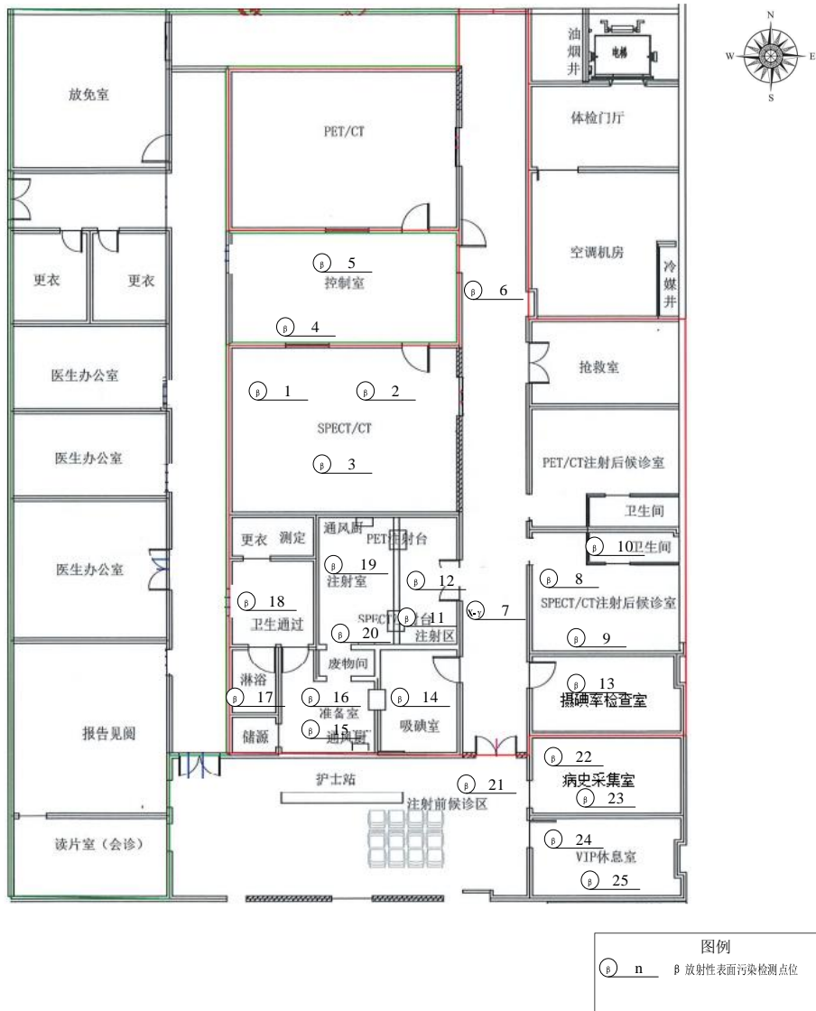
图 7-6 核医学工作场所 β 表面污染水平现场检测点位示意图
