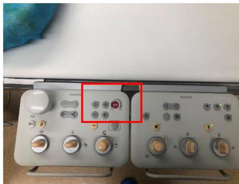
图3-9 DSA控制室及机房内的急停按钮
