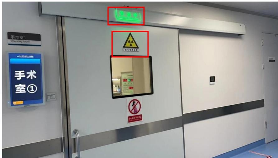
图3-3 门诊楼三层手术室1工作状态指示灯和电离辐射警告标志
