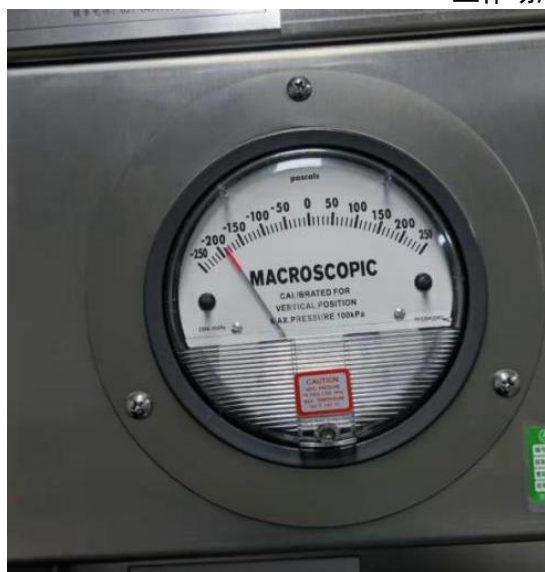
手套箱气压表（负压状态）
