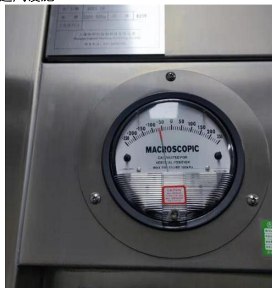
手套箱气压表（负压状态）
