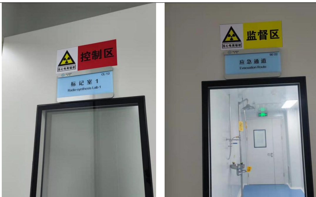
图3-3 放射性同位素实验室场所入口及实验室房间门上电离辐射警告标志
