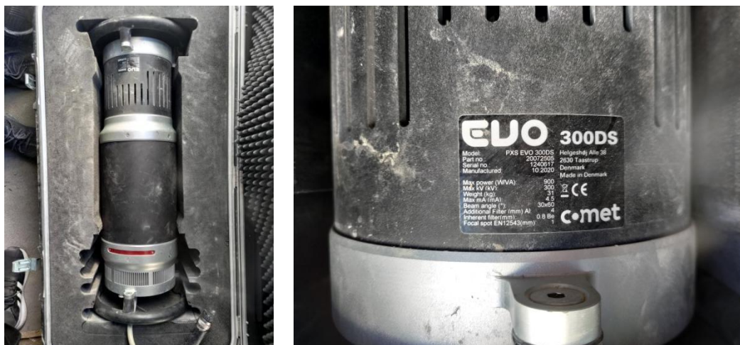
图3-3 本项目X射线探伤机外观及铭牌
