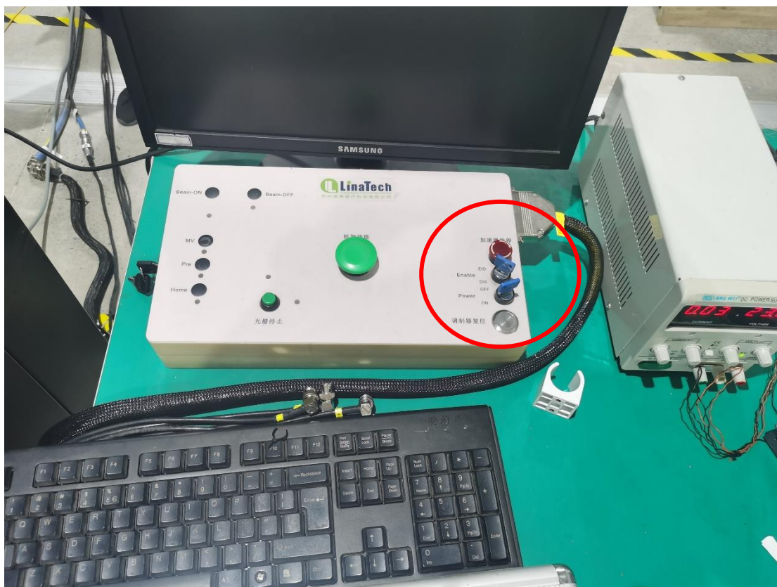
图 4-10 7#医用直线加速器测试机房控制台上钥匙开关
