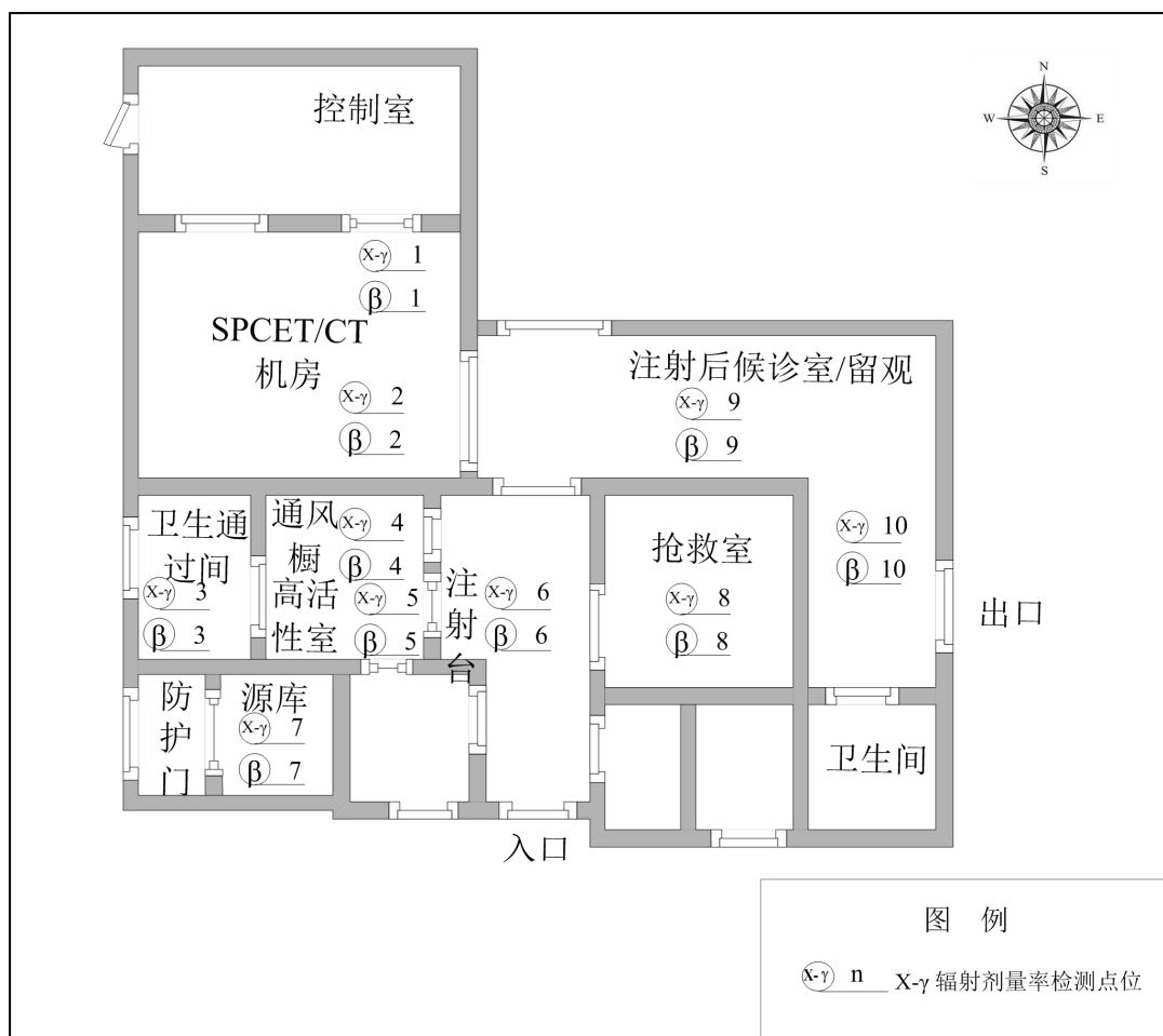
图 9-2 核医学科工作场所 X-γ辐射剂量率、β放射性表面污染水平监测点位图
