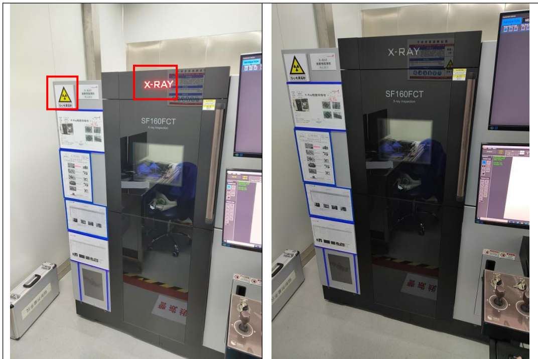
图3-4 X-ray检测机上电离辐射警告标志及工作指示灯
