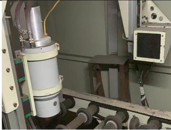
图2-1 本项目XYD-22507型X射线数字成像装置
