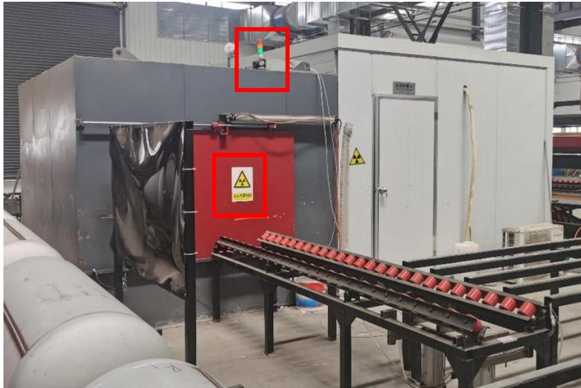
图3-2-1 本项目探伤室1工作状态指示灯和电离辐射警告标志
