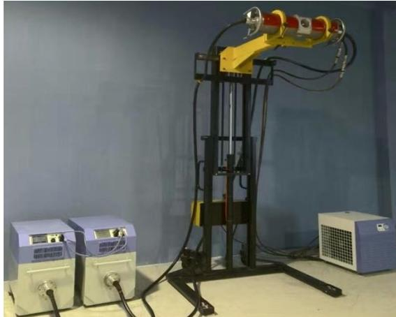
图2-3 本项目ZXF-LaseeS型X射线数字成像装置
