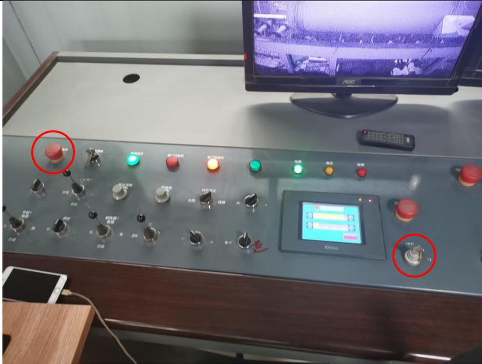
图3-3-2本项目探伤室2操作台设置急停按钮及钥匙开关
