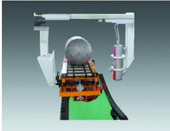
图2-2 本项目XYG-22508/3型X射线数字成像装置
