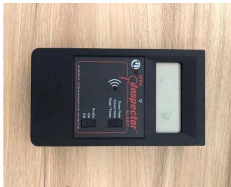
图 4-12 辐射巡测仪和表面污染仪
