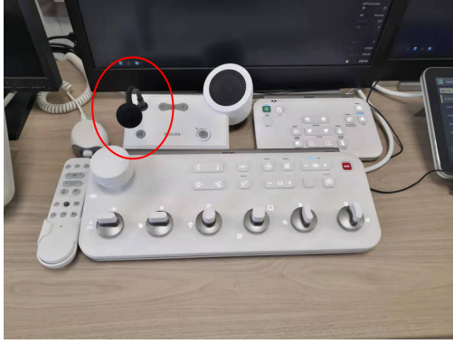
1号手术室操作台语音对讲装置
