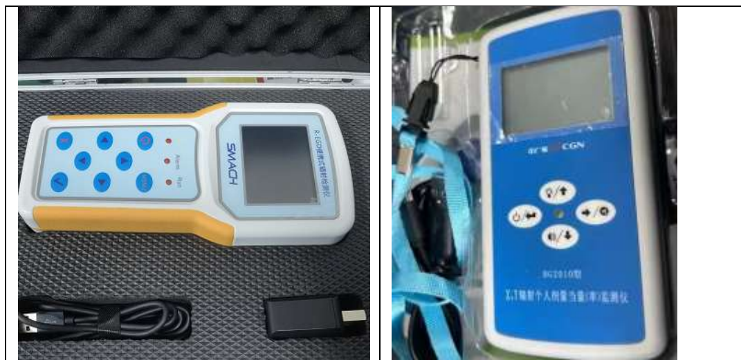
图 3-7 本项目配备辐射监测仪器
