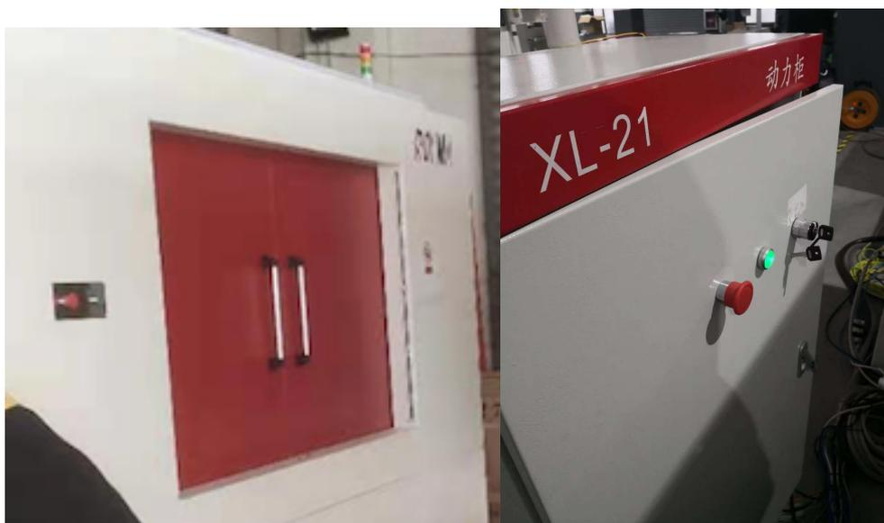
图 4-5 急停开关和急停按钮
