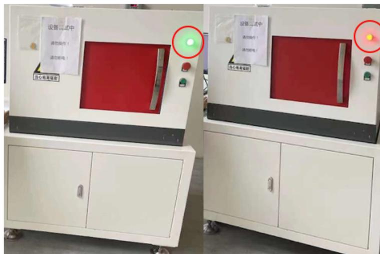
注：RMCT1000 型工业 CT 检测装置指示灯，设备通电时为绿灯，射线开启后为红灯。
