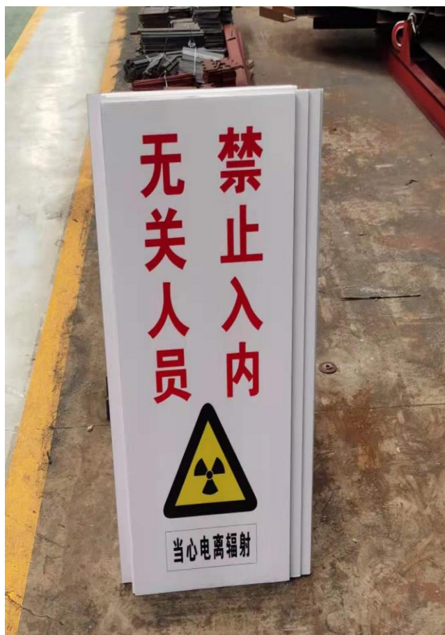
图 4-2-2 移动探伤工作场所监督区外警告牌和电离辐射警告标志
