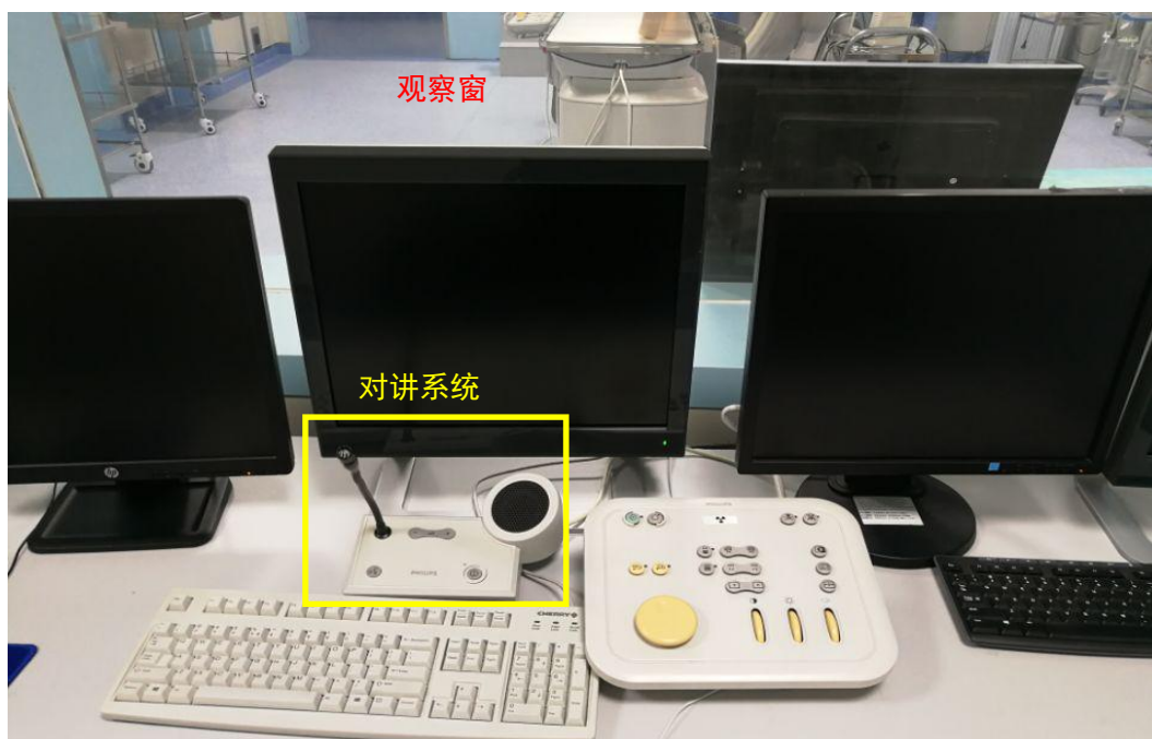
图4-4 DSA机房观察窗及对讲系统
