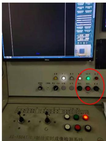
图4-3 新增1台X射线实时成像检测系统操作台急停按钮
