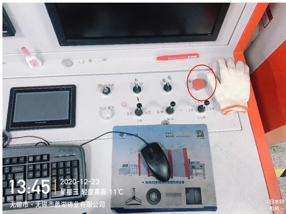
图4-3 新增1台X射线实时成像检测装置操作台急停按钮
