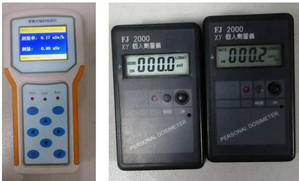
图 4-4 辐射巡测仪及个人剂量报警仪
