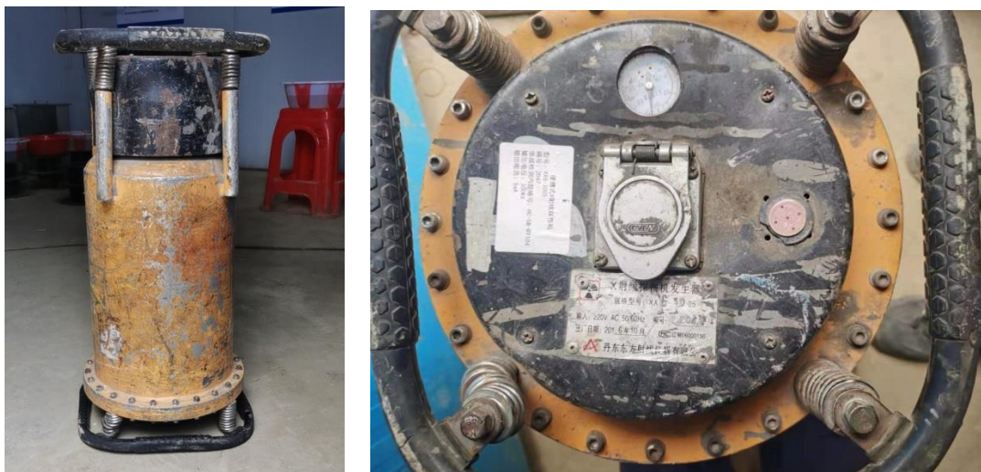
图3-3 本项目X射线探伤机外观
