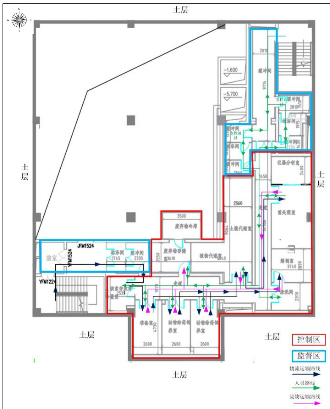
图 4-1 放射性同位素实验室平面布置、分区及人员流动路线示意图
