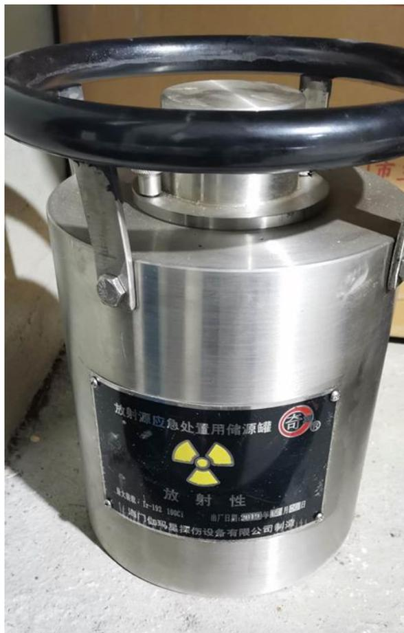
图 4-10 放射源应急处置用储源罐
