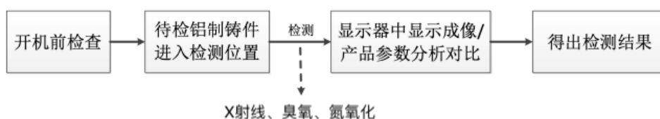
图 3-7 X 射线实时成像装置工作流程及产污环节示意图
