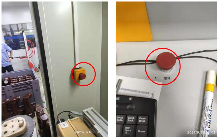
图 4-5 UNC160 型 X 射线实时成像设备急停按钮
