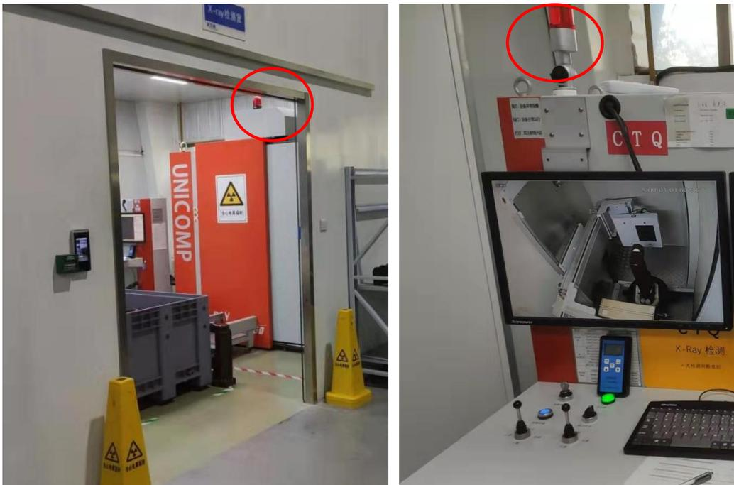
图 4-3 UNC160 型 X 射线实时成像设备工作状态指示灯
