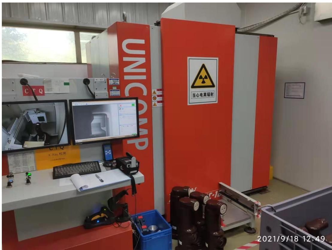
图 3-6 UNIC160 型 X 射线实时成像检测装置现场图
