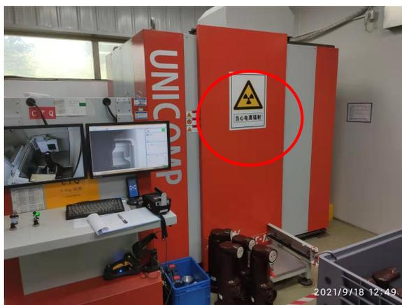
图 4-2 UNC160 型 X 射线实时成像设备电离辐射警告标志
