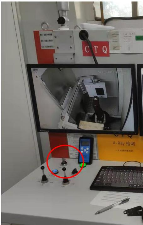
图 4-4 UNC160 型 X 射线实时成像设备钥匙开关
