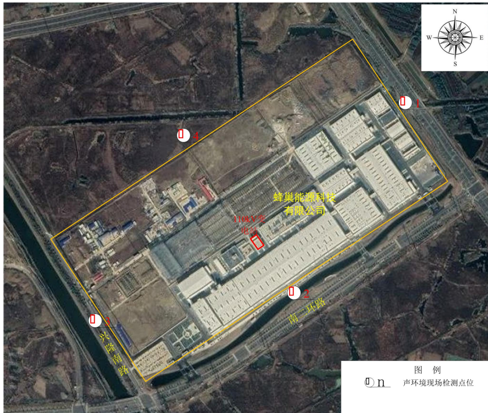
图 7-2 本项目所在厂区厂界声环境现场检测点位示意图
