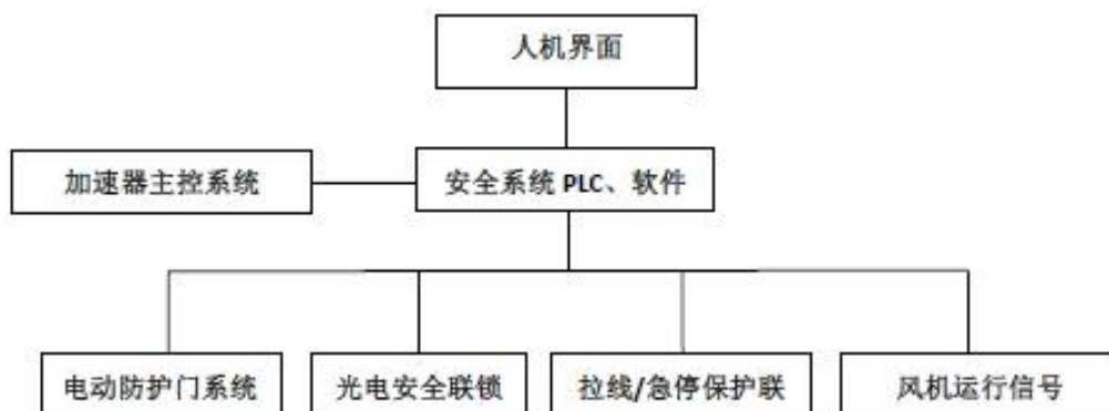
图 4-19 加速器独立安全系统逻辑关系示意图
