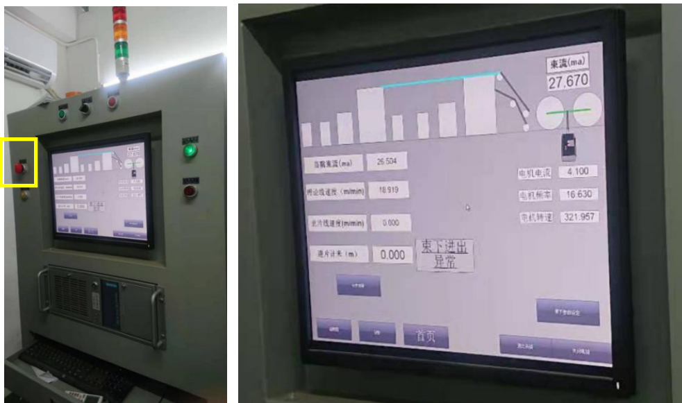
图 4-4 工业辐照加速器控制台束下控制系统及界面（方框处为急停按钮）
