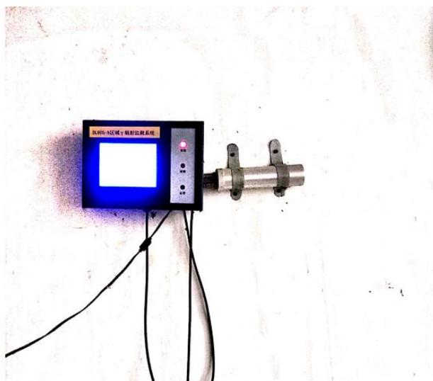
控制室内辐射检测报警仪控制系统控制面板
