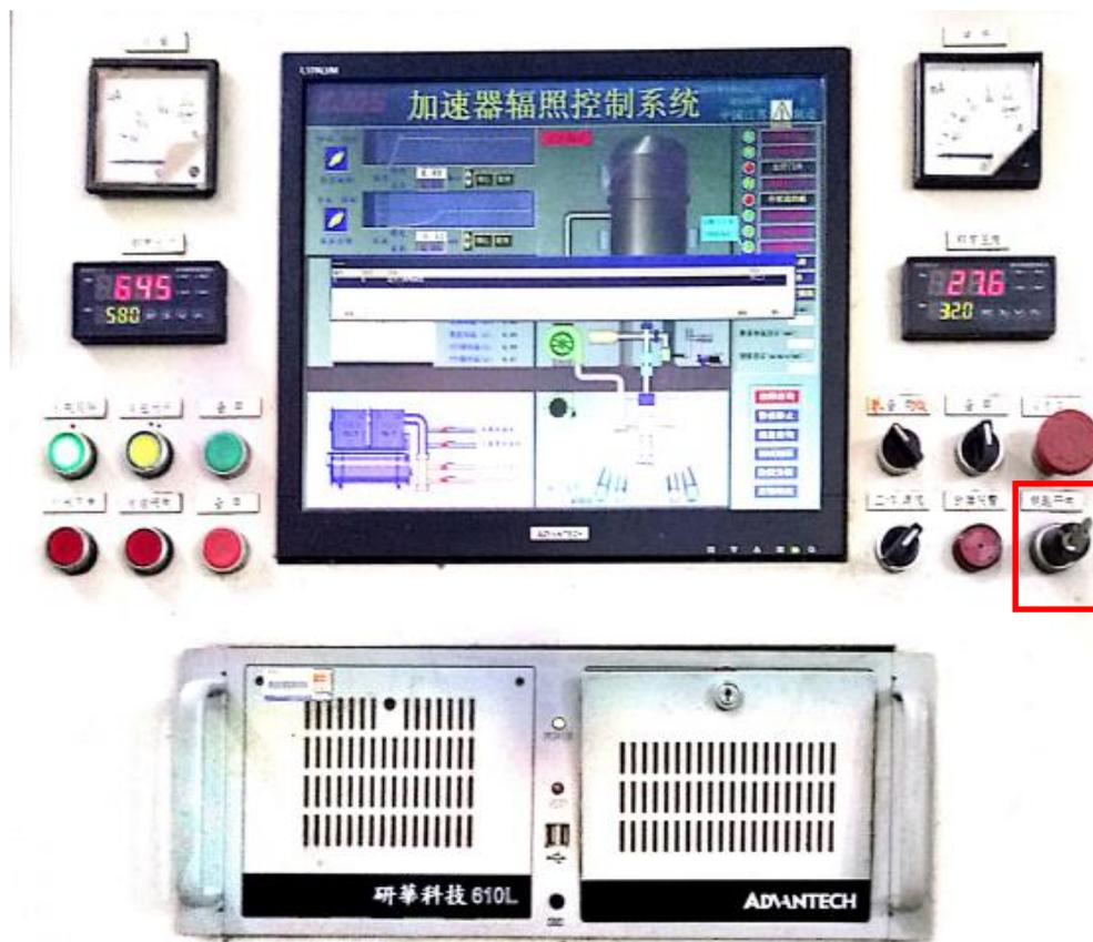
图 4-2 工业辐照加速器控制台上钥匙开关
