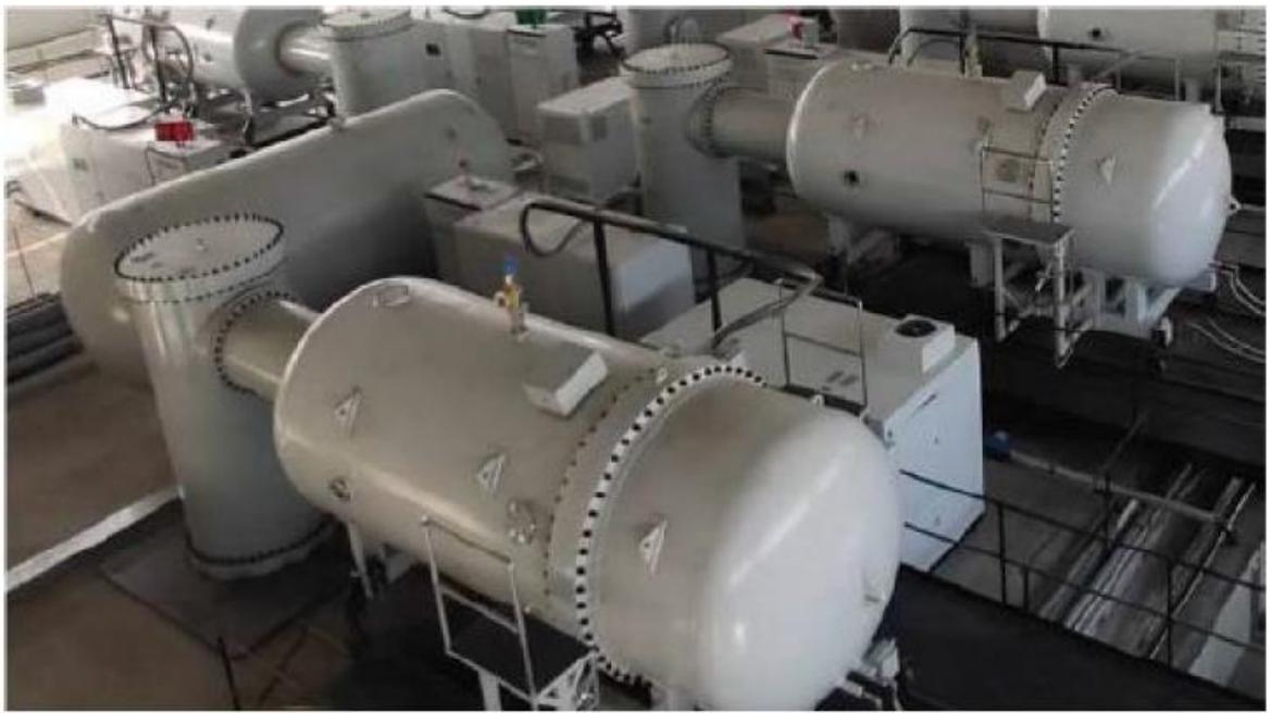
图 9-1 卧式工业电子加速器主机钢桶
