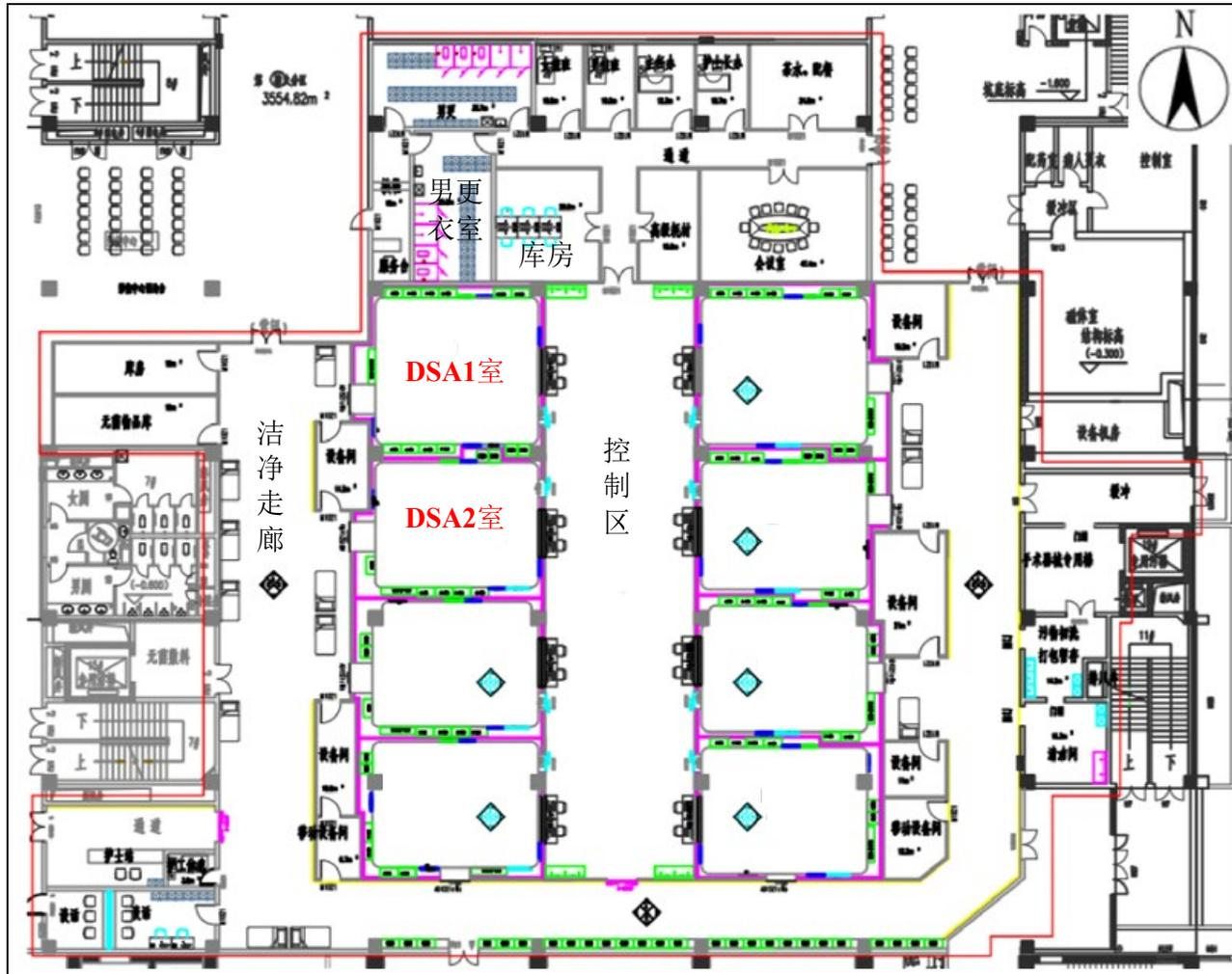
图 3-7 介入导管室平面布置示意图
